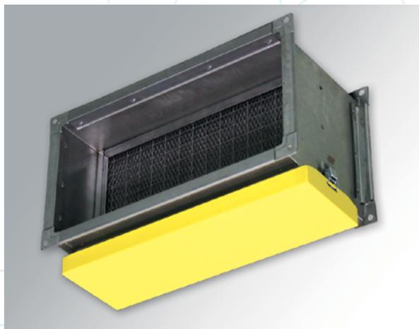
Фильтры жирославливающие для прямоугольных каналов предназначены для очистки от взвеси твердых частиц и аэрозолей (жира) рециркуляционного и вытяжного воздуха в системах вентиляции и кондиционирования. Основная область применения данных изделий это объекты на которых возможно попадание в вытяжную вентиляцию жира и крупных частиц – кухни, рестораны, кафе, столовые.
